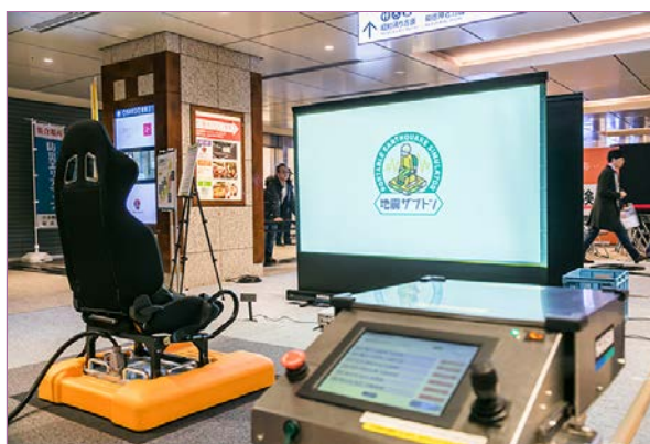
▶ 大規模地震発生時のデータを元にしたシミュレーター「地震ザブトン」
