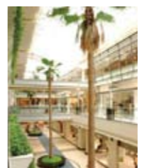
空調負荷・照明の低減のためにトップライトを配置
